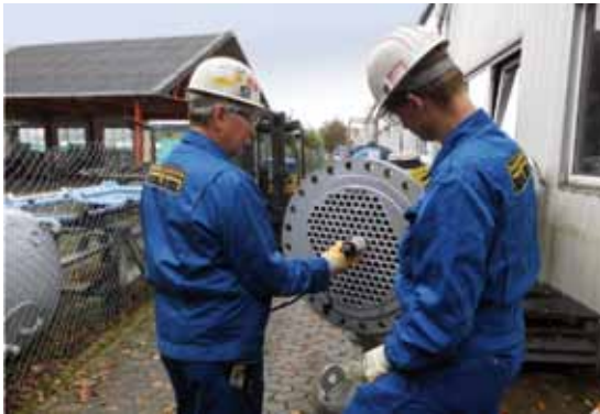
Abb. 9: Installation der Stopfen in der Praxis
