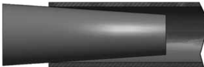
Abb. 2: Zerstörendes Reparaturverfahren bei Niederdruckerwendungen
