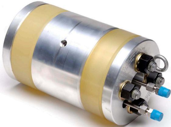
Der Double Block and Bleed (DBB) Stopfen revolutioniert die Isolierung und Prüfung von Rohrverbindungen. Der DBB-Stopfen ermöglicht dem Bediener die sichere Isolierung und Kontrolle potentiell explosiver Dämpfe während feuergefährlicher Arbeiten und der anschließenden Druckprüfung der neuen Schweißverbindung mit einem einfach zu bedienenden Werkzeug.
