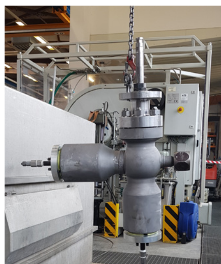
Bild 5: Druckprobe mit Grip-Tight-Prüfstopfen an einem BR 450 Dampf-Regelventil der Firma Waldemar Pruss
